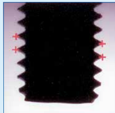
Gewindebeschädigungen Endommagement du filetage
