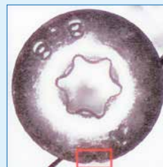
Kopfriss Fissures de tête
