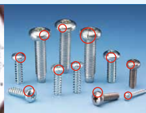
Fissures de tête latérales sur vis zinguées
