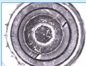
Kopfrisse an der Seite bei schwarzen Schrauben
