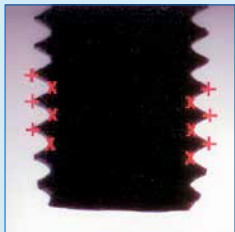
Gewindedurchmesser innen/ausser, Gewindesteigung, Gewindeform Diamètre de filetage intérieur/extérieur, pas de filetage, forme du filetage
