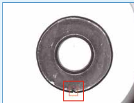
Kopfrisse Fissure de tête
