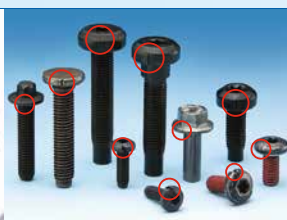
Fissures de tête latérales sur vis noires
